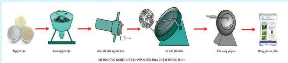
Hình 1. Sơ đồ công nghệ chế tạo phân bón nhả chậm thông minh
