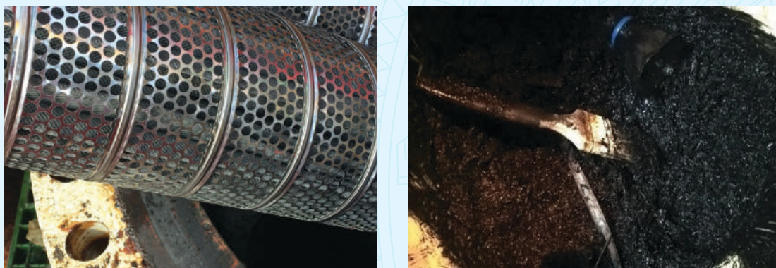
Hình 1. Filter chính hãng và lượng cặn bẩn thu được quá nhiều
